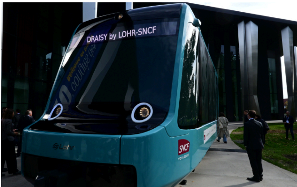
Le train léger de Lohr pèse 20 tonnes et peut accueillir 80 passagers — Photo :
